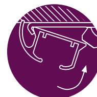
Eenvoudige te monteren: inklikken-positioneren-vastzetten
